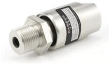
DK11A系列单通道旋转接头，接口尺寸G1/8"，结构紧凑，重量轻，耐腐蚀，采用不锈钢轴和铝制外壳。所有DK系列机型均标配阳螺纹轴和阴螺纹外壳，便于安装。
